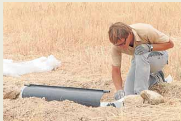
Instalación en parcelas experimentales para medir la erosión que sufre el campo. :: CEBAS-CSIC
