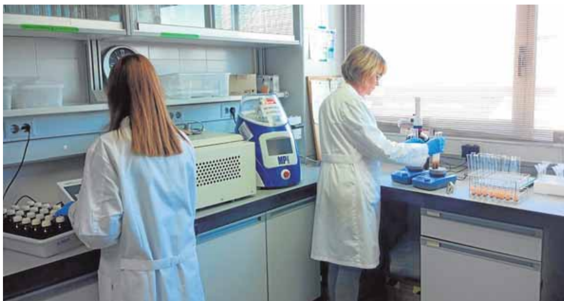
Medición en laboratorio del CO 2 en suelos mediante un detector de infrarrojos. CEBAS-CSIC
